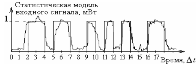
Рис. 4.4. Статистическая модель цифрового сигнала с учетом шума, джиттера и ДВИ в канале передачи Е1. Ровными линиями представлен идеальный сигнал в коде СМ1 (с инверсией комбинаций) [20]
